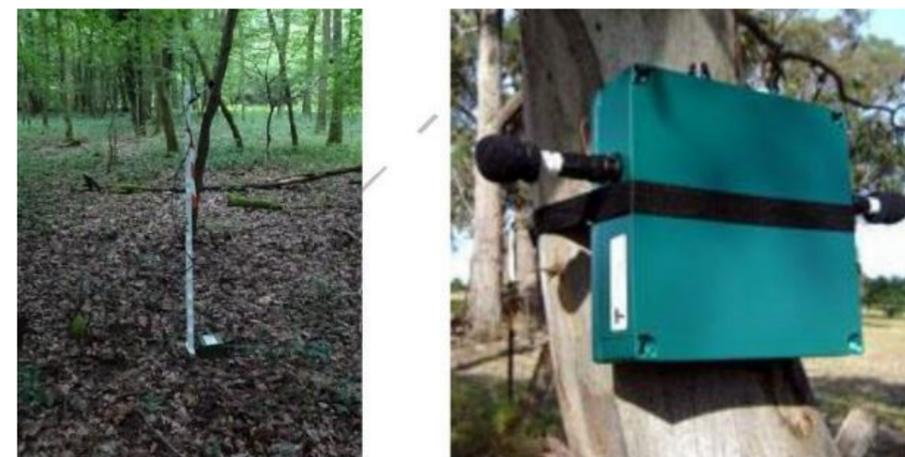
Figure 222 : SM4Bat (à gauche) et SM2Bat (à droite) (source : Ecosphère, 2019)
